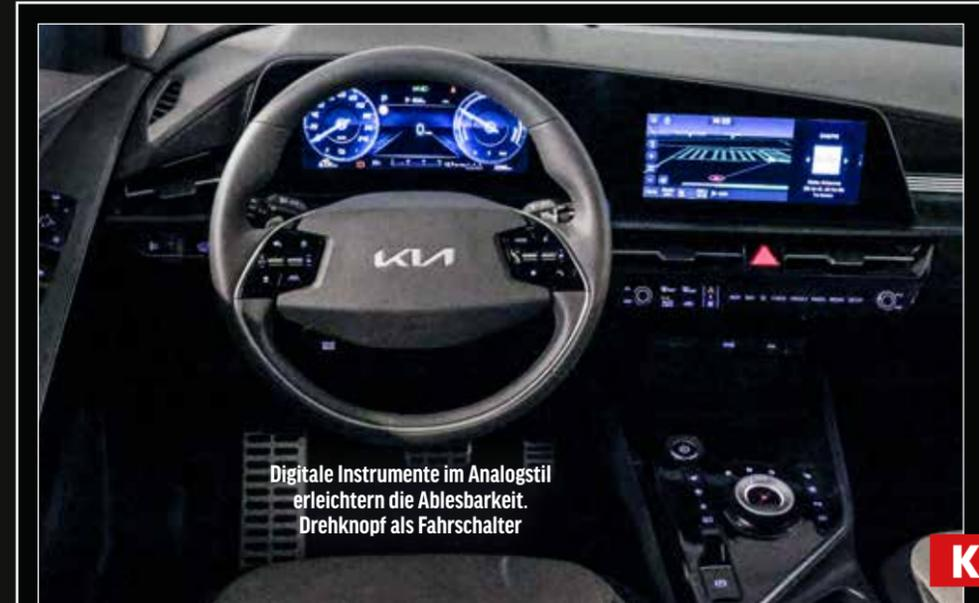
Digitale Instrumente im Analogstil erleichtern die Ablesbarkeit. Drehknopf als Fahrshalter
