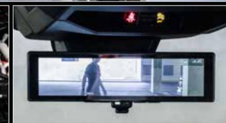
Umschaltbar: Innenspiegel mit Rückfahrkamera-Bild
