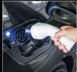
Je nach Stromquelle sind bis zu 120 Kilowatt Ladeleistung möglich
