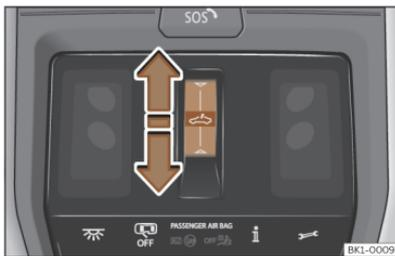
**Abb. 112** Im Dachhimmel: Funktionsfläche zur Bedienung des Sonnenschutzrollos.
