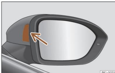
Abb. 138 Kontrollleuchte des Spurwechselassistenten.
