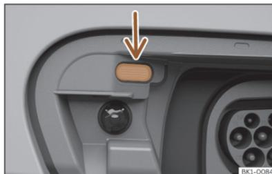
Abb. 70 Hinter der Batterieladeklappe: Ladevorgangsanzeige.
