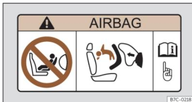
**Abb. 51** Airbag-Label: an der Sonnenblende Beifahrerseite.
