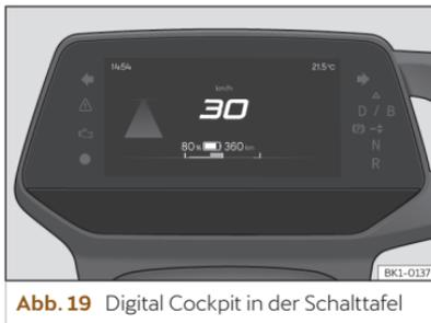
Abb. 19 Digital Cockpit in der Schalttafel
