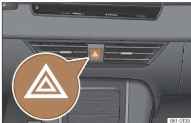
**Abb. 60** Instrumententafel: Schalter für die Warnblinkanlage
