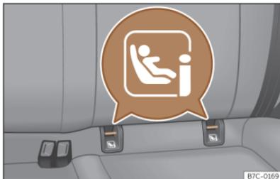
**Abb. 52** Rücksitz: Einbauort der Halteösen ISOFIX oder i-Size.
