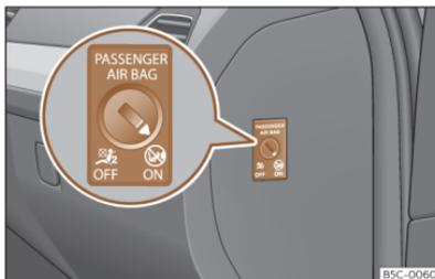
**Abb. 43** Schlüsselschalter zum Ein- und Abschalten des Beifahrerairbags.
