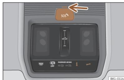
**Abb. 61** In der Dachkonsole: Schalter für Sprachdienste.
