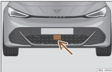
**Abb. 118** Im vorderen Stoßfänger: Radarsensor.
