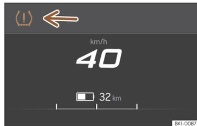
**Abb. 203** Kombi-Instrument: Warnung Reifendruckverlust.
