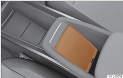
**Abb. 167** In der Mittelkonsole: Aufnahme für die Mobiltelefonkopplung.
