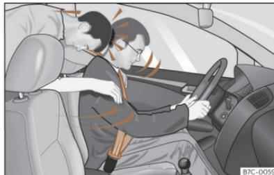
**Abb. 36** Der nicht angegurte Mitfahrer auf dem Rücksitz wird nach vorn auf den angegurten Fahrer geschleudert.
