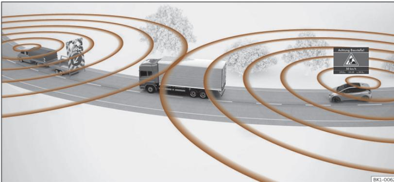
Die Gefahrenwarnung verwendet das verbundene Car2X und weist gemäß der jeweiligen Situation auf Gefahrenpunkte in der Umgebung hin. In diesem Modus können Unfälle vermieden und der Verkehrsfluss verbessert werden.
