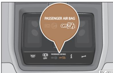
**Abb. 44** In der Dachkonsole: Kontrollleuchte für Airbag Beifahrerseite aus.
