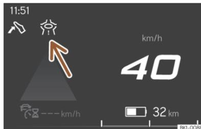
**Abb. 25** Anzeige des Assistenten für eine ökologische Fahrweise (schematische Darstellung).
