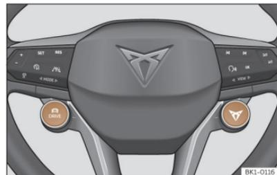
**Abb. 117** Multifunktionslenkrad: Tasten DRIVE und CUPRA, um das Fahrprofil auszuwählen und zu wechseln.
