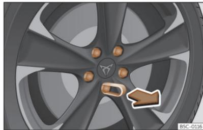
Abb. 198 Rad: Radschrauben mit Deckel.
