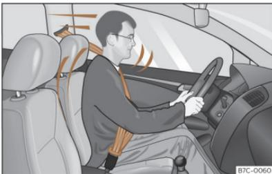
**Abb. 33** Richtig angegurte Fahrer werden bei einem plötzlichen Bremsmanöver nicht nach vorne geschleudert.
