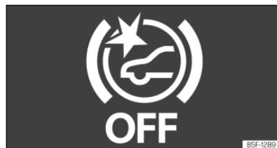
**Abb. 132** Auf dem Display des Kombi-Instruments: Anzeige, dass Front Assist ausgeschaltet ist.
