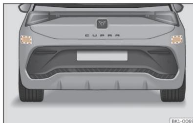
**Abb. 121** Bereich hinter dem Fahrzeug: Bereiche der Radarsensoren.
