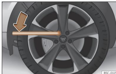
**Abb. 200** Radwechsel: Radschrauben lockern
