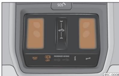
**Abb. 105** Ausschnitt aus Dachhimmel: Innenbeleuchtung vorn.
