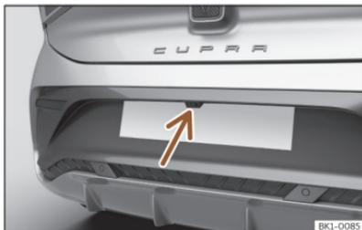
**Abb. 123** Im Stoßfänger hinten: Einbauort der Rückfahrkamera.
