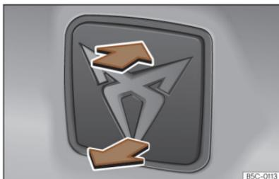
**Abb. 89** Heckklappe: Öffnen von außen
