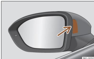
Abb. 137 Kontrollleuchte des Spurwechselassistenten.
