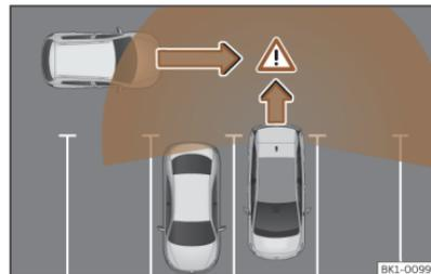
**Abb. 154** Schematische Abbildung des Ausparkassistenten: Überwacher Bereich des ausparkenden Fahrzeugs.
