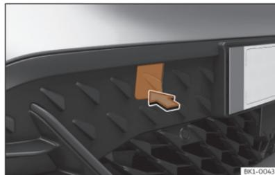
**Abb. 183** Auf der rechten Seite des vorderen Stoßfängers: Abdeckung entfernen.
