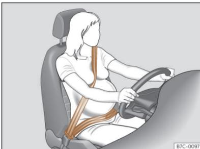
**Abb. 40** Gurtbandverlauf bei schwangeren Frauen.
