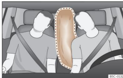
**Abb. 46** Vollständig entfalteter Center-Airbag (Entfaltungsbereich)
