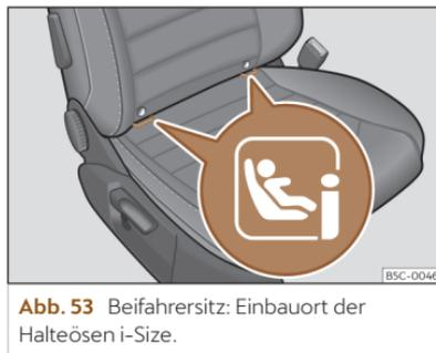
**Abb. 53** Beifahrersitz: Einbauort der Halteösen i-Size.
