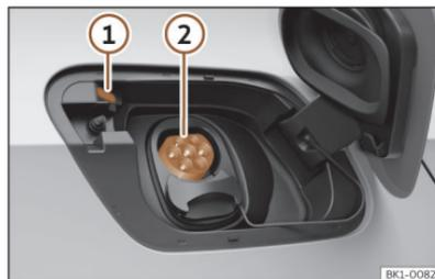
**Abb. 68** Hinter der Batterieladeklappe hinten rechts: Ladedose.
