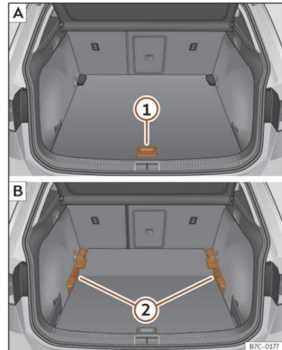
**Abb. 161** Variabler Gepäckraumboden: **A** Hochstellung; **B** Tiefstellung.
