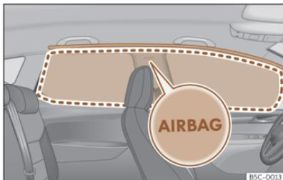
Abb. 29 Einbauort der Kopfairbags
