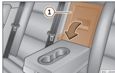
Abb. 168 An der Rücksitzlehne: Öffnung der Durchladeeinrichtung.
