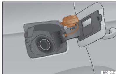
**Abb. 176** Tankklappe mit aufgestecktem Tankverschluss.
