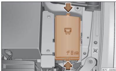
**Abb. 189** Im Motorraum: Abdeckung des Sicherungskastens.
