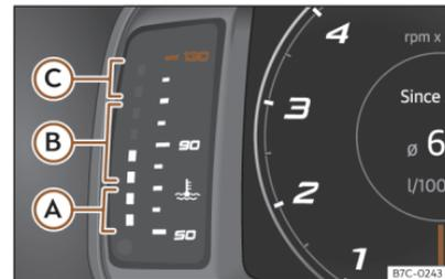
Abb. 4 Motorkühlmittel-Temperaturanzeige
