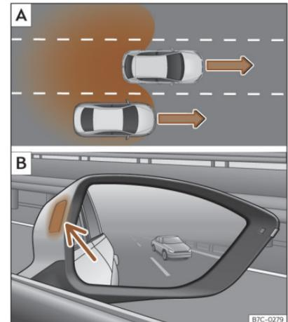
**Abb. 123** Schematische Darstellung: **A** Überholen auf der mittleren Spur und anschließender Wechsel auf die rechte Fahrbahn. **B** Anzeige des Spurwechselassistenten rechts.
