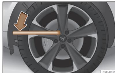
**Abb. 209** Radwechsel: Radschrauben lockern
