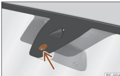
**Abb. 83** Sensitive Fläche des Regensensors.
