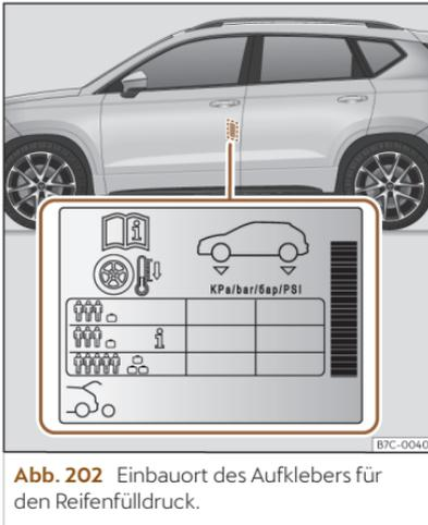
**Abb. 202** Einbauort des Aufklebers für den Reifendruck.
