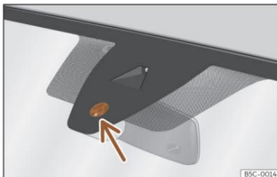
**Abb. 87** Feuchtigkeits- und Temperatursensor der Windschutzscheibe.
