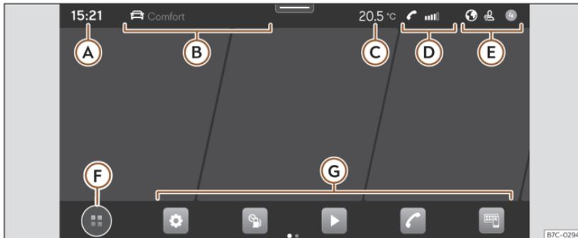
**Abb. 9** Schematische Darstellung: Übersicht möglicher Funktionsflächen am Bildschirm.
