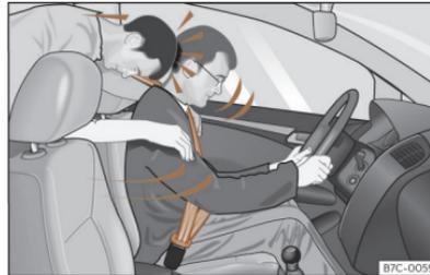
**Abb. 18** Der nicht angeschnallte Mitfahrer auf dem Rücksitz wird nach vorn auf den angeschnallten Fahrer geschleudert.
