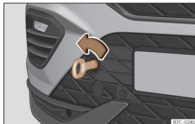
**Abb. 184** Vorderer Stoßfänger rechts: Eingeschraubte Abschleppöse
