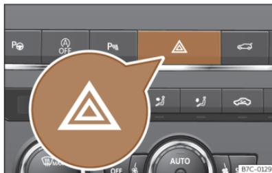
**Abb. 40** Instrumententafel: Schalter für die Warnblinkanlage
