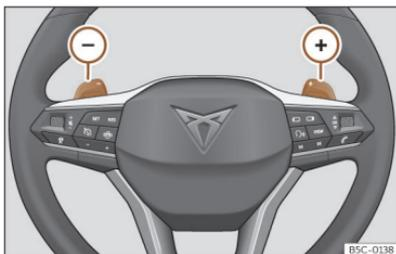
**Abb. 94** Lenkrad: die Hebel für Automatikgetriebe.
