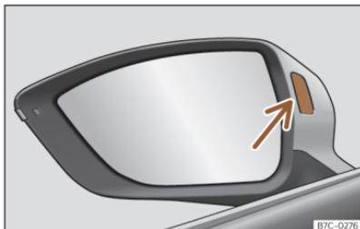
Abb. 120 Kontrollleuchte des Spurwechselassistenten.
