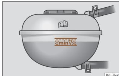
**Abb. 193** Im Frontraum: Markierung am Kühlmittelausgleichsbehälter.
