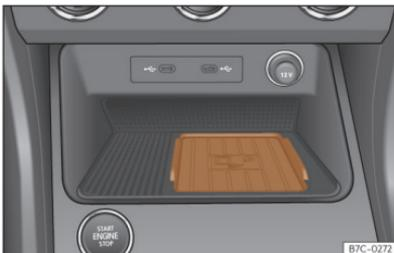
**Abb. 156** In der Mittelkonsole: Aufnahme für die Mobiltelefonkopplung.
