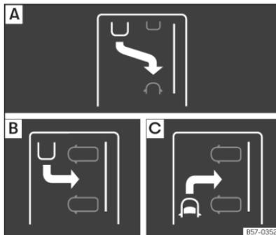
**Abb. 133** Im Bildschirm des Kombi-Instruments: Anzeige der Parkmodi.
