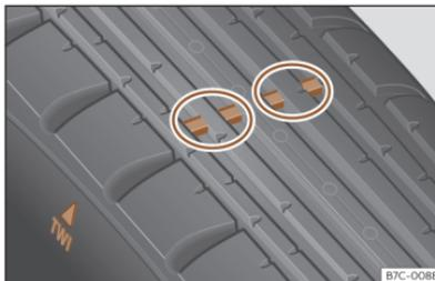
Abb. 203 Reifenprofil: Verschleißanzeiger.
