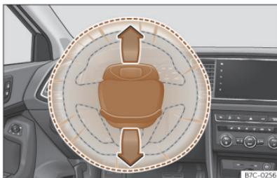
**Abb. 23** Einbauort Fahrerairbag: im Lenkrad.
