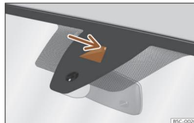
Abb. 103 Kamerasichtfenster des Spurhalteassistenten.
