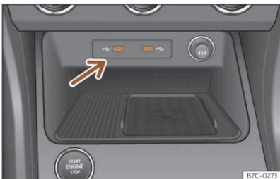
**Abb. 149** Mittelkonsole: USB-Eingang.
