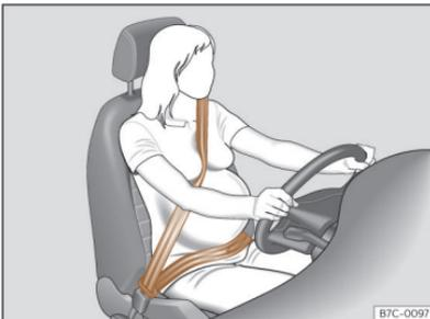
**Abb. 22** Gurtbandverlauf bei schwangeren Frauen.
