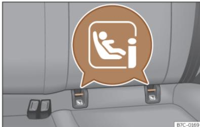
**Abb. 35** Rücksitz: Einbauort der Halteösen ISOFIX oder i-Size.
