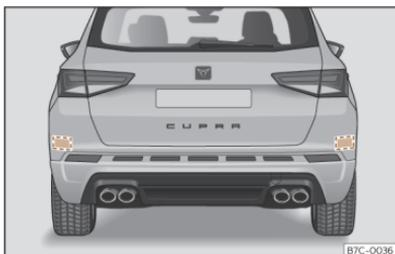
**Abb. 104** Bereich hinter dem Fahrzeug: Bereiche der Radarsensoren.
