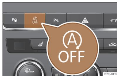
**Abb. 91** Mittelkonsole: Systemtaste Start-Stopp.
