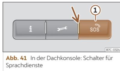
**Abb. 41** In der Dachkonsole: Schalter für Sprachdienste
