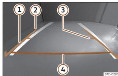
Abb. 137 Bildschirm des Infotainment-Systems: Orientierungslinien.
