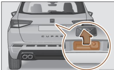
Abb. 54 Heckklappe: Öffnen von außen
