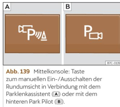
**Abb. 139** Mittelkonsole: Taste zum manuellen Ein-/Ausschalten der Rundumsicht in Verbindung mit dem Parklenkassistenten (A) oder mit dem hinteren Park Pilot (B).
