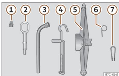
**Abb. 178** Im Gepäckraum unter dem Gepäckraumboden: Bordwerkzeug.
