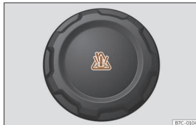
**Abb. 194** Frontraum: Verschlussdeckel des Kühlmittelausgleichsbehälters.
