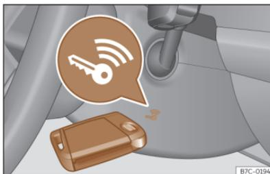
**Abb. 90** Rechts an der Lenksäule: Notstart.
