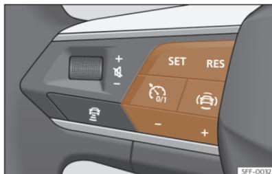
**Abb. 108** Am Multifunktionslenkrad: Tasten zur Bedienung des Geschwindigkeitsbegrenzers.
