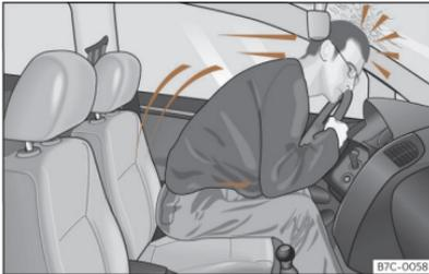
**Abb. 17** Der nicht angeschnallte Fahrer wird nach vorn geschleudert.
