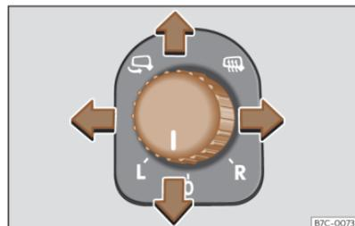
**Abb. 84** Ausschnitt der Fahrertür: Außenspiegelbedienung.
