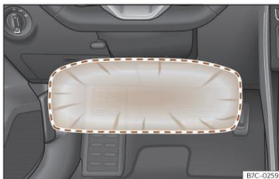
**Abb. 31** Auf der Fahrerseite: Wirkungsbereich des Knieairbags.
