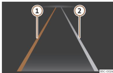
**Abb. 117** Im Display des Kombi-Instruments: Anzeigen des Spurhalteassistenten.
