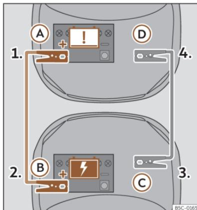
**Abb. 182** Anschlussschema für Fahrzeuge mit Start-Stopp-System.
