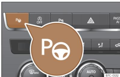
**Abb. 131** In der Mittelkonsole oben: Taster für Parklenkassistent.
