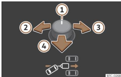
**Abb. 141** Drehknopf für die Außenspiegel: Ausrichtung des Anhängers einstellen.
