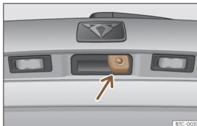
**Abb. 106** Im Griff der Heckklappe: Umfeldkamera.
