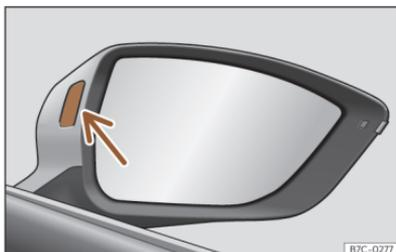
Abb. 121 Kontrollleuchte des Spurwechselassistenten.
