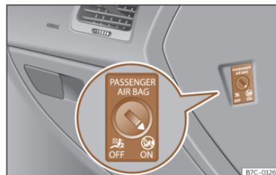
**Abb. 25** Schlüsselschalter zum Ein- und Abschalten des Beifahrerairbags.
