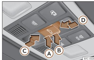
**Abb. 61** Im Dachhimmel: Bedienelement für Panorama-Schiebedach.
