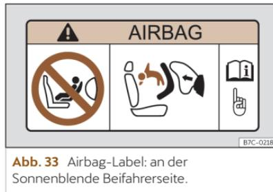
**Abb. 33** Airbag-Label: an der Sonnenblende Beifahrerseite.
