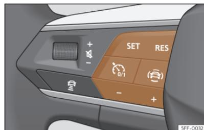
**Abb. 107** Am Multifunktionslenkrad: Tasten zur Bedienung der Geschwindigkeitsregelanlage.
