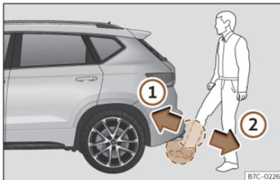
Abb. 57 Heckklappe mit sensorgesteuerter Öffnung (Easy Open).
