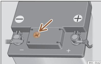
**Abb. 201** Sichtfenster an der Oberseite der 12-Volt-Fahrzeuggatterie (Prinzipdarstellung).
