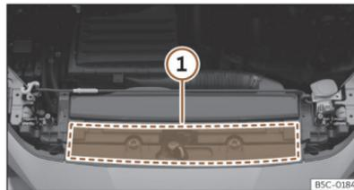
**Abb. 198** Im Motorraum: Position des Aufklebers mit Motoröl-Spezifikationen
