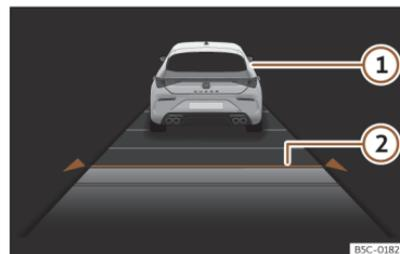
**Abb. 109** Am Bildschirm des Kombi-Instruments: ACC aktiv.
