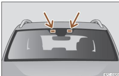
**Abb. 88** Bereiche für das Anbringen elektronischen Zubehörs
