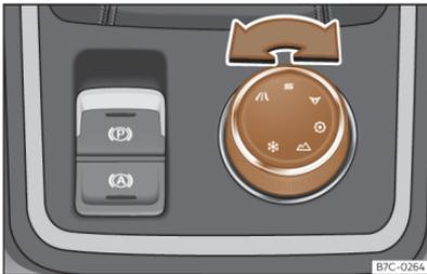
**Abb. 96** Mittelkonsole: Drehknopf (Driving Experience button).
