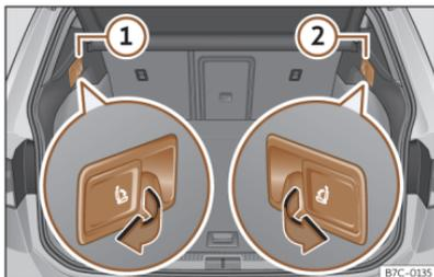
**Abb. 77** Im Gepäckraum: Hebel zum Entriegeln der Rücksitzlehne.
