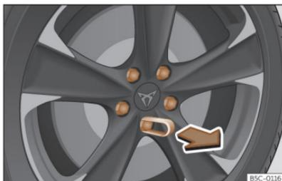
**Abb. 207** Rad: Radschrauben mit Deckel.
