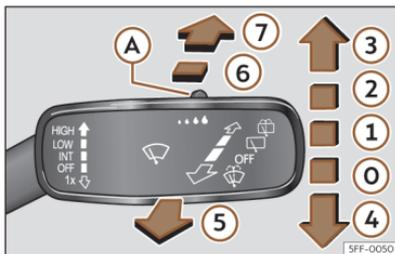
Abb. 81 Bedienung von Windschutz- und Heckscheibenwischer
