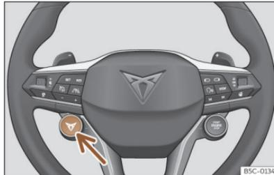
**Abb. 97** Multifunktionslenkrad: Schalter für den Fahrprofilwechsel.
