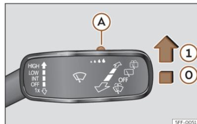
Abb. 82 Scheibenwischerhebel: Regensensor (A) einstellen.
