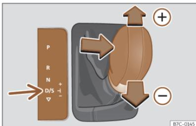
**Abb. 93** Mittelkonsole: zu Tiptronic ändern.
