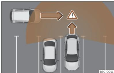
**Abb. 143** Schematische Abbildung des Ausparkassistenten: Überwachter Bereich des ausparkenden Fahrzeugs.
