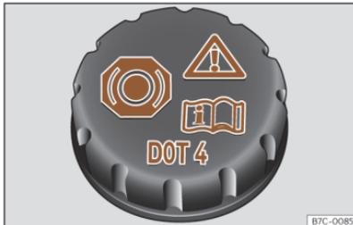
Abb. 195 Motorraum: Deckel des Bremsflüssigkeitsbehälters
