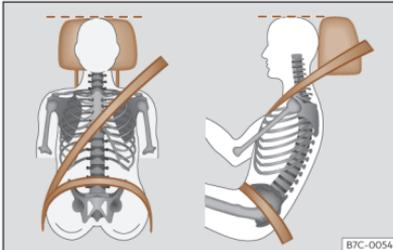
**Abb. 14** Richtiger Gurtbandverlauf und richtige Kopfstützeinstellung.
