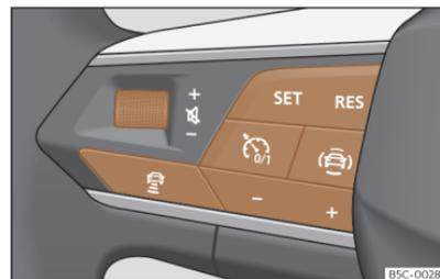
**Abb. 110** Am Multifunktionslenkrad: Tasten zur ACC-Bedienung.
