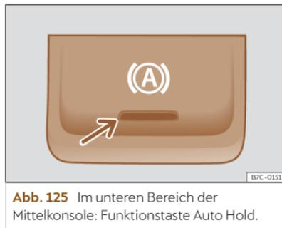
**Abb. 125** Im unteren Bereich der Mittelkonsole: Funktionstaste Auto Hold.
