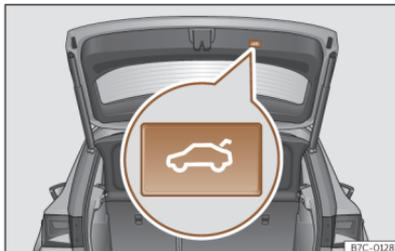
**Abb. 55** Heckklappe: Taste zum Schließen der Heckklappe.
