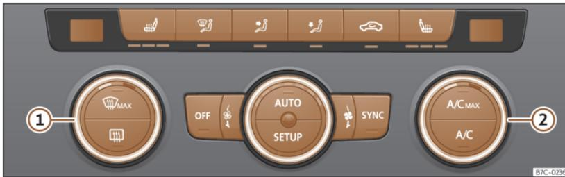
**Abb. 86** In der Mittelkonsole: Bedienelemente der Climatronic.
