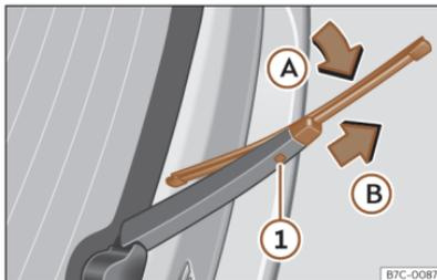
**Abb. 181** Scheibenwischerblatt der Heckscheibe auswechseln.
