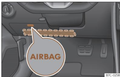
**Abb. 30** Auf der Fahrerseite: Einbauort des Knieairbags.
