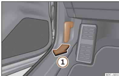
**Abb. 191** Entriegelungshebel im Fahrerfußraum.
