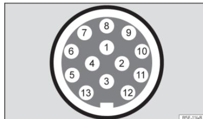
Abb. 171 Schematische Darstellung: Zuweisung der Steckverbinderstifte für Anhängerstrom.
