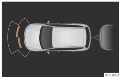
**Abb. 127** Bildschirmanzeige der Einparkhilfe im Anhängerbetrieb.
