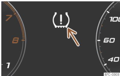
**Abb. 212** Kombi-Instrument: Warnung Reifendruckverlust.
