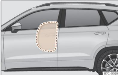
**Abb. 28** Kompletzt aufgeblasener Seitenairbag auf der linken Fahrzeugseite.
