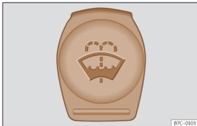
**Abb. 196** Im Motorraum: Blauer Deckel des Scheibenwaschbehälters.
