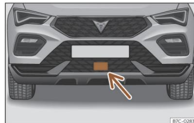
**Abb. 101** Im vorderen Stoßfänger: Radarsensor.
