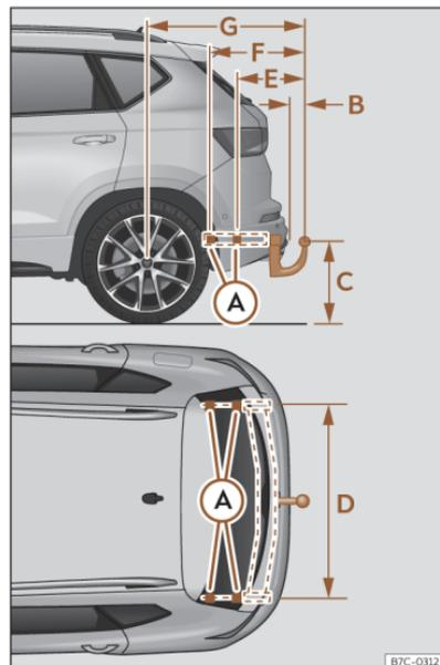
**Abb. 175** Maße und Befestigungspunkte für den nachträglichen Einbau einer Anhängervorrichtung
