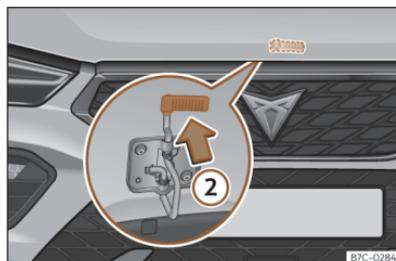
**Abb. 192** Hebel unter der Motorraumklappe.
