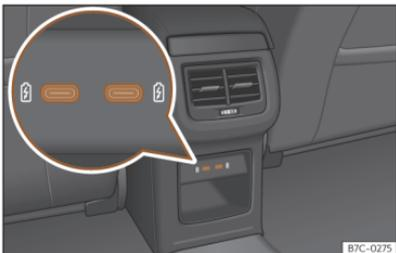
**Abb. 150** Mittelkonsole hinten: USB-Anschlüsse mit Steckdosenfunktion.
