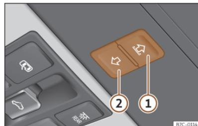
**Abb. 63** Im Dachhimmel: Funktionsfläche zur Bedienung des Sonnenschutzrollos.
