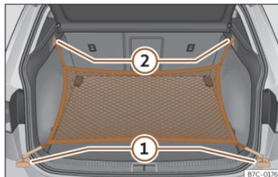
**Abb. 166** Im Gepäckraum: Ösen ① und Haken ② zum Einhängen des Gepäckraumnetzes.
