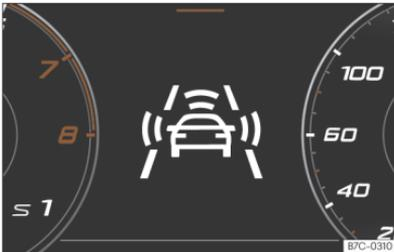
**Abb. 114** Im Display des Kombi-Instruments: Vorwarnhinweise.
