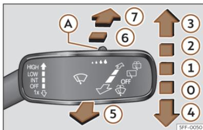
Abb. 103 Bedienung von Windschutz- und Heckscheibenwischer
