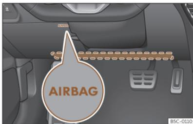
**Abb. 36** Auf der Fahrerseite: Einbauort des Knieairbags.
