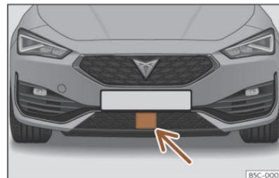
**Abb. 121** Im vorderen Stoßfänger: Radarsensor.
