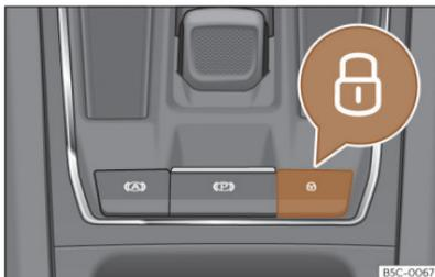
**Abb. 71** In der Mittelkonsole: Zentralverriegelungstaster
