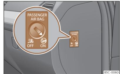
**Abb. 29** Schüsselschalter zum Ein- und Abschalten des Beifahrerairbags.
