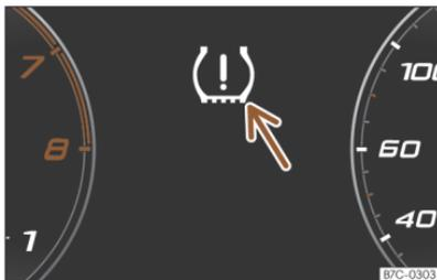
Abb. 237 Kombi-Instrument: Warnung Reifendruckverlust.
