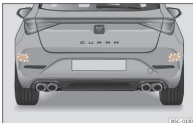
**Abb. 124** Bereich hinter dem Fahrzeug: Bereiche der Radarsensoren.
