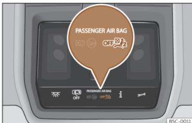
**Abb. 30** In der Dachkonsole: Kontrollleuchte für Airbag Beifahrerseite aus.
