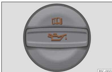
Abb. 223 Deckel der Motoröl-Einfüllöffnung im Motorraum.
