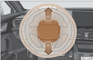
**Abb. 27** Einbauort Fahrerairbag: im Lenkrad.
