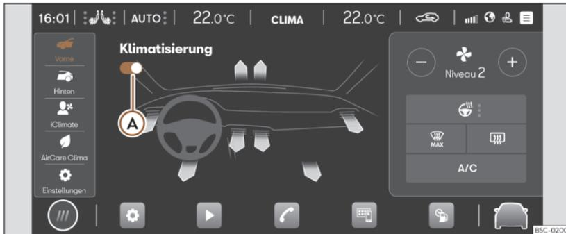
Abb. 109 Schematische Darstellung: Menü Klimatisierung.
