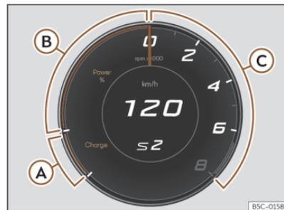
Abb. 7 Digitales Kombi-Instrument: Powermeter (Ansicht Cupra)
