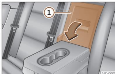
**Abb. 190** An der Rücksitzlehne: Öffnung der Durchladeeinrichtung.
