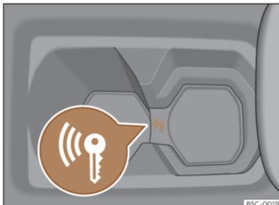
Abb. 112 In der Mittelkonsole: Notstart.
