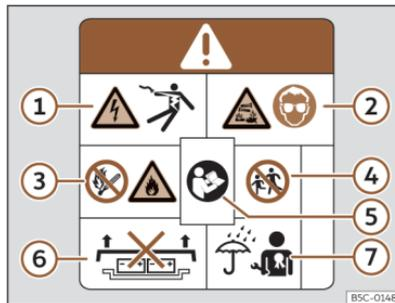
Abb. 53 Warnschild auf der Hochvoltbatterie.
