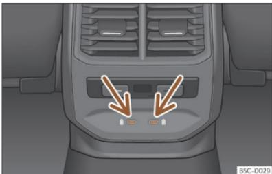
**Abb. 164** Mittelkonsole hinten: USB-Anschlüsse mit Steckdosenfunktion.
