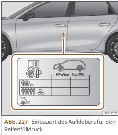
**Abb. 227** Einbauposition des Aufklebers für den Reifendruck.
