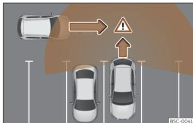
**Abb. 155** Schematische Abbildung des Ausparkassistenten: Überwachter Bereich des ausparkenden Fahrzeugs.
