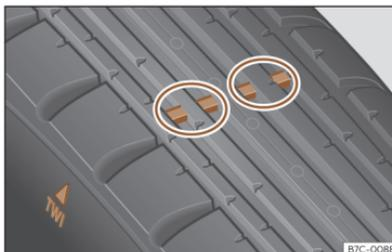
Abb. 228 Reifenprofil: Verschleißanzeiger.
