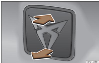
**Abb. 75** Heckklappe: Öffnen von außen
