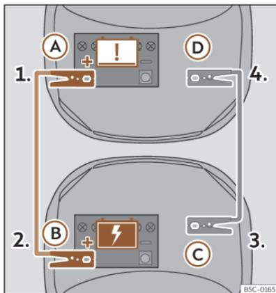
**Abb. 205** Anschlusschema für Fahrzeuge mit Start-Stopp-System.
