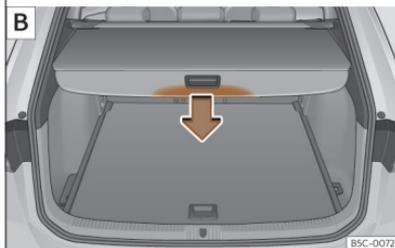
**Abb. 175** Im Kofferraum: Abdeckung ausziehen und einrollen.
