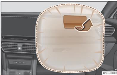
**Abb. 28** Beifahrerairbag in der Instrumententafel
