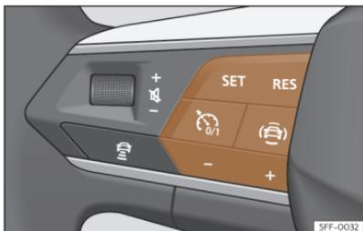
**Abb. 127** Am Multifunktionslenkrad: Tasten zur Bedienung der Geschwindigkeitsregelanlage.
