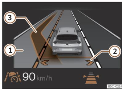
**Abb. 140** Im Display des Kombi-Instruments: Anzeige des assistierten Spurwechsels (schematische Darstellung).
