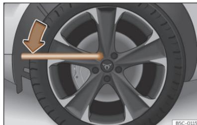
**Abb. 234** Radwechsel: Radschrauben lockern
