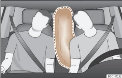
**Abb. 32** Vollständig entfalteter Center-Airbag (Entfaltungsbereich)
