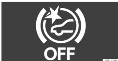
**Abb. 136** Auf dem Display des Kombi-Instruments: Anzeige, dass Front Assist ausgeschaltet ist.
