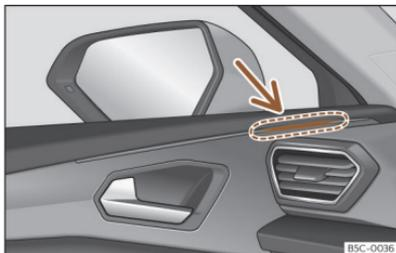
Abb. 141 Kontrollleuchte des Spurwechselassistenten.
