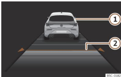
**Abb. 129** Am Bildschirm des Kombi-Instruments: ACC aktiv.
