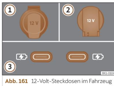
Abb. 161 12-Volt-Steckdosen im Fahrzeug
