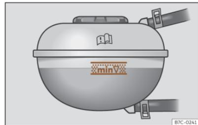
Abb. 216 Im Frontraum: Markierung am Kühlmittelausgleichsbehälter.
