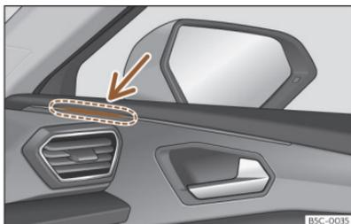
Abb. 142 Kontrollleuchte des Spurwechselassistenten.
