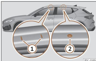
**Abb. 193** Befestigungspunkte der Längsträger für den Dachgepäckträger (Leon).
