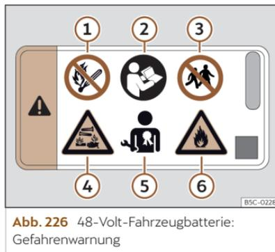
Abb. 226 48-Volt-Fahrzeugbatterie: Gefahrenwarnung
