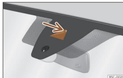
Abb. 123 Kamerasichtfenster des Spurhalteassistenten.
