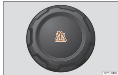
Abb. 217 Frontraum: Verschlussdeckel des Kühlmittelausgleichsbehälters.
