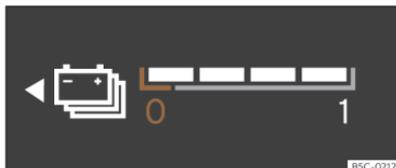
**Abb. 5** Digitales Kombi-Instrument: Anzeige des Batterieladezustands.
