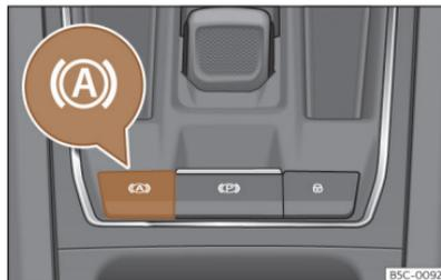
**Abb. 146** Im unteren Bereich der Mittelkonsole: Funktionstaste Auto Hold.
