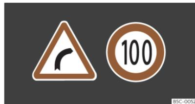
**Abb. 9** Im Display des Kombi-Instruments: Beispiel für erkannte Verkehrszeichen.
