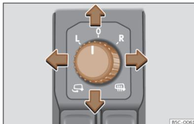
**Abb. 106** Ausschnitt der Fahrertür: Außenspiegelbedienung.
