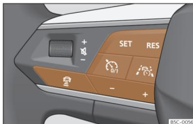
Abb. 139 Linke Seite des Multifunktionslenkrads.
