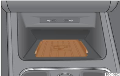
**Abb. 170** In der Mittelkonsole: Aufnahme für die Mobiltelefonkopplung.
