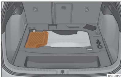
**Abb. 224** Plug-in-Hybridfahrzeuge (PHEV): Einbauort der Batterie im Kofferraum
