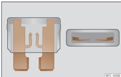
**Abb. 212** Darstellung einer durchgebrannten Sicherung.
