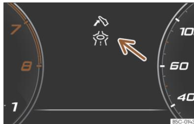
**Abb. 10** Anzeige des Assistenten für eine ökologische Fahrweise (schematische Darstellung).
