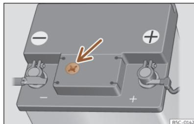
**Abb. 225** Sichtfenster an der Oberseite der 12-Volt-Fahrzeugbatterie (Prinzipdarstellung).
