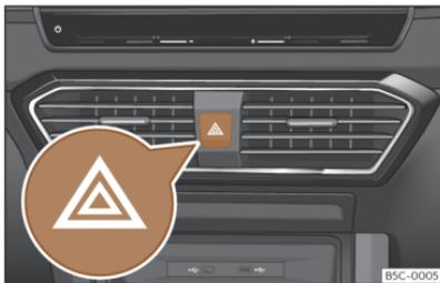
**Abb. 49** Instrumententafel: Schalter für die Warnblinkanlage
