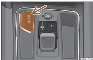
Abb. 64 Mittelkonsole: Aufnahme für den Fahrzeugschlüssel
