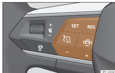
**Abb. 128** Am Multifunktionslenkrad: Tasten zur Bedienung des Geschwindigkeitsbegrenzers.
