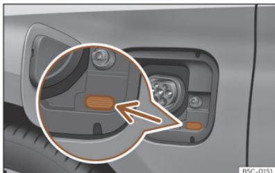
**Abb. 57** Hinter der Batterieladeklappe: Ladevorgangsanzeige.
