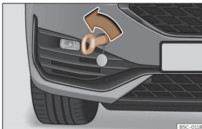
**Abb. 207** Vorderer Stoßfänger rechts: Eingeschraubte Abschleppöse
