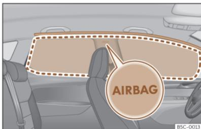
Abb. 35 Einbauort der Kopfairbags
