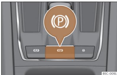
**Abb. 145** Im unteren Bereich der Mittelkonsole: Taste für die elektronische Parkbremse.
