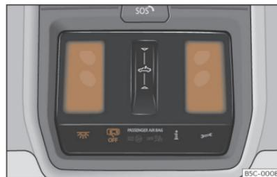
Abb. 101 Ausschnitt aus Dachhimmel: Innenbeleuchtung vorn.
