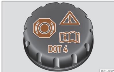
Abb. 218 Motorraum: Deckel des Bremsflüssigkeitsbehälters
