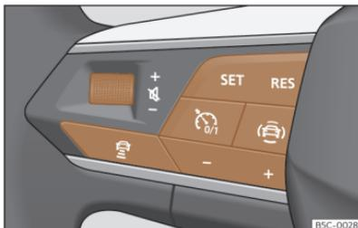
**Abb. 130** Am Multifunktionslenkrad: Tasten zur ACC-Bedienung.
