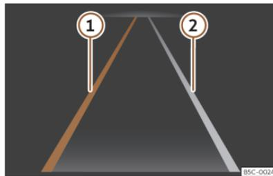
**Abb. 137** Im Display des Kombi-Instruments: Anzeigen des Spurhalteassistenten.
