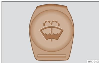
**Abb. 219** Im Motorraum: Blauer Deckel des Scheibenwaschbehälters.
