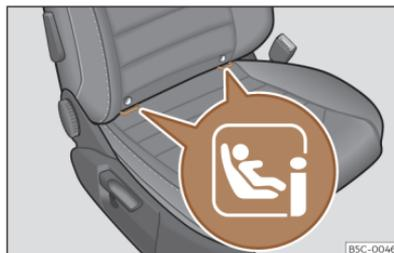
**Abb. 42** Beifahrersitz: Einbauort der Halteösen i-Size.
