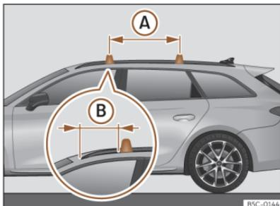
**Abb. 192** Befestigungspunkte der Längsträger für den Dachgepäckträger (Leon Sportstourer).
