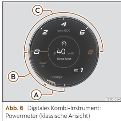
Abb. 6 Digitales Kombi-Instrument: Powermeter (klassische Ansicht)
