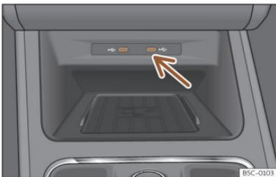
**Abb. 163** Mittelkonsole: USB-Eingang.
