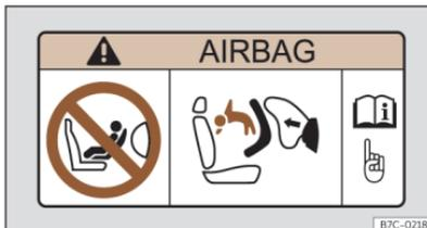
**Abb. 39** Airbag-Label: an der Sonnenblende Beifahrerseite.
