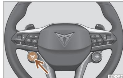
**Abb. 117** Multifunktionslenkrad: Schalter für den Fahrprofilwechsel.
