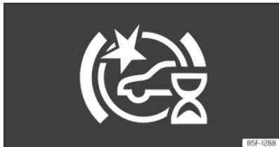
**Abb. 135** Im Display des Kombi-Instruments: Anzeige der ersten Selbstkalibrierung des Systems.
