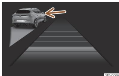
Abb. 131 Am Bildschirm des Kombi-Instruments: ACC aktiv, Fahrzeug auf der linken Seite erkannt.
