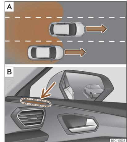
**Abb. 144** Schematische Darstellung: **A** Überholen auf der mittleren Spur und anschließender Wechsel auf die rechte Fahrbahn. **B** Anzeige des Spurwechselasistenten rechts.
