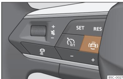
**Abb. 120** Linke Seite des Multifunktionslenkrads: Taste für die Fahrerassistenzsysteme (modellabhängig).
