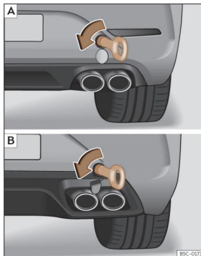
**Abb. 209** Auf der rechten Seite des hinteren Stoßfängers: Eingeschraubte Abschleppöse. **A** Leon Sportstourer; **B** Leon.
