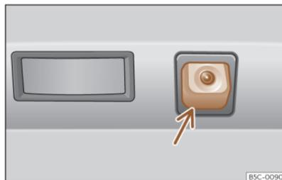
**Abb. 126** Im Stoßfänger hinten: Einbauort der Rückfahrkamera.
