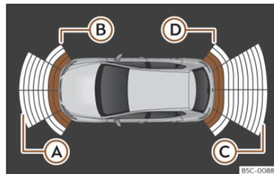
Abb. 147 Anzeige der Einparkhilfe auf dem Bildschirm des Infotainment-Systems.
