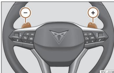
**Abb. 116** Lenkrad: die Hebel für Automatikgetriebe.
