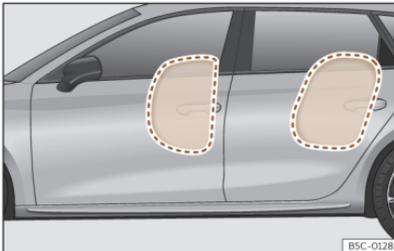
**Abb. 34** Komplette aufgeblasene Seitenairbags auf der linken Fahrzeugseite
