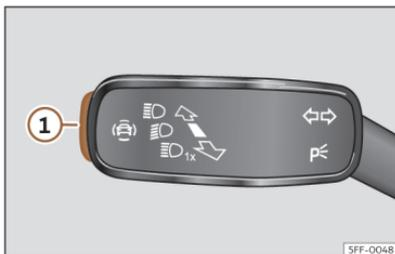
**Abb. 119** Am Blinker- und Fernlichthebel: Taste für die Fahrerassistenzsysteme (modellabhängig).
