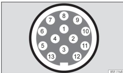
**Abb. 194** Schematische Darstellung: Zuweisung der Steckverbinderstifte für Anhängerstrom.
