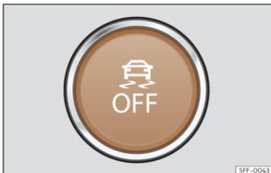
**Abb. 118** Im unteren Bereich der Mittelkonsole: Taste zum Ein-/Ausschalten von ESC
