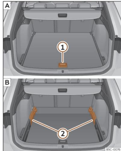
**Abb. 179** Variabler Gepäckraumboden: **A** Hochstellung; **B** Tiefstellung.
