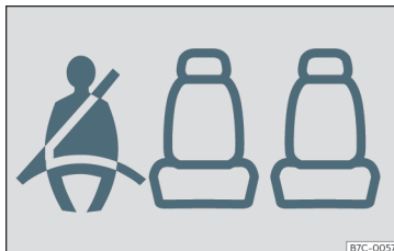
Abb. 5 Kombi-Instrument: Anzeige, dass der Platz hinten links besetzt ist und der Mitfahrer seinen Sicherheitsgurt angelegt hat.
