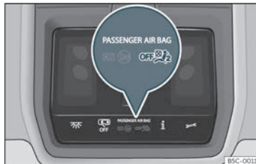
Abb. 16 In der Dachkonsole: Kontrollleuchte für Abschaltung der Beifahrerairbags.
