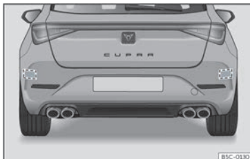
Abb. 151 Heckansicht des Fahrzeugs: Bereiche der Radarsensoren.
