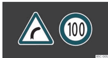
Abb. 54 Am Bildschirm des Kombi-Instruments: Beispiel für erkannte Verkehrszeichen.
