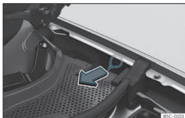
Abb. 194 Zwischen dem linken Kotflügel und dem Scharnier der Frontklappe: Ziehgriff für manuelle Notentriegelung des Ladesteckers.
