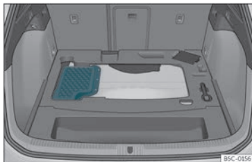
Abb. 211 Einbauort der Batterie im Kofferraum
