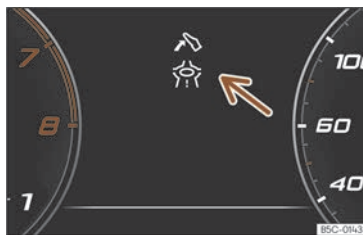
Abb. 7 Anzeige des Assistenten für eine ökologische Fahrweise (schematische Darstellung).
