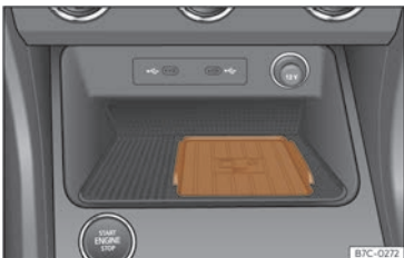
Abb. 156 In der Mittelkonsole: Aufnahme für die Mobiltelefonkopplung.
