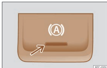
Abb. 125 Im unteren Bereich der Mittelkonsole: Funktionstaste Auto Hold.
