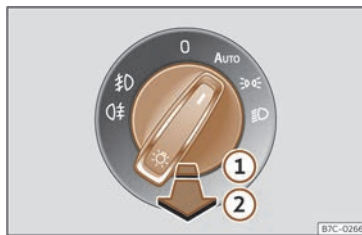
Abb. 79 Instrumententafel: Bedienelement Licht
