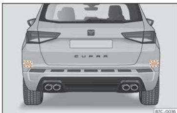
Abb. 104 Bereich hinter dem Fahrzeug: Bereiche der Radarsensoren.
