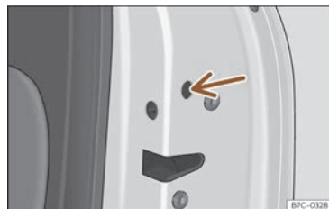
Abb. 52 Notfallsperrung der Tür.
