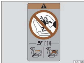
Abb. 34 Airbag-Label: am hinteren Rahmen der Beifahrertür.
