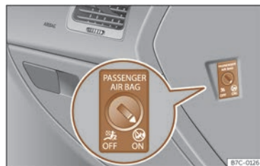
Abb. 25 Schlüsselschalter zum Ein- und Abschalten des Beifahrerairbags.
