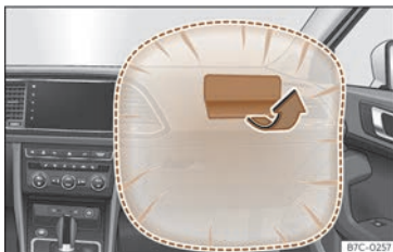
Abb. 24 Beifahrerairbag in der Instrumententafel
