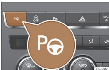
Abb. 131 In der Mittelkonsole oben: Taster für Parklenkassistent.
