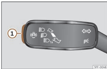
Abb. 99 Am Blinker- und Fernlichthebel: Taste für die Fahrerassistenzsysteme (modellabhängig).
