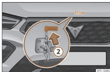
Abb. 192 Hebel unter der Motorraumklappe.
