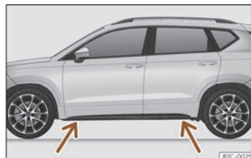
Abb. 210 Aufnahmepunkte für den Wagenheber.
