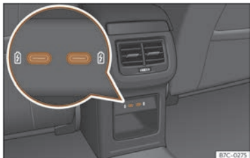
Abb. 150 Mittelkonsole hinten: USB-Anschlüsse mit Steckdosenfunktion.
