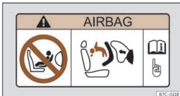
Abb. 33 Airbag-Label: an der Sonnenblende Beifahrerseite.
