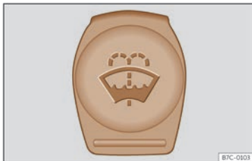
Abb. 196 Im Motorraum: Blauer Deckel des Scheibenwaschbehälters.
