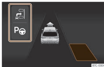
Abb. 132 Am Bildschirm des Kombi-Instruments: Anzeige des Parklenkassistenten mit eingeschränkter Sicht.
