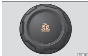
Abb. 194 Frontraum: Verschlussdeckel des Kühlmittelausgleichsbehälters.
