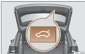
Abb. 55 Heckklappe: Taste zum Schließen der Heckklappe.
