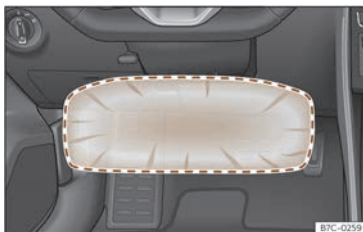
Abb. 31 Auf der Fahrerseite: Wirkungsbereich des Knieairbags.
