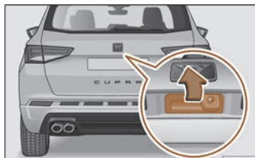
Abb. 54 Heckklappe: Öffnen von außen
