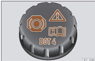
Abb. 195 Motorraum: Deckel des Bremsflüssigkeitsbehälters
