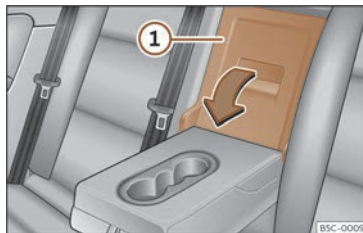
Abb. 168 An der Rücksitzlehne: Öffnung der Durchladeeinrichtung.
