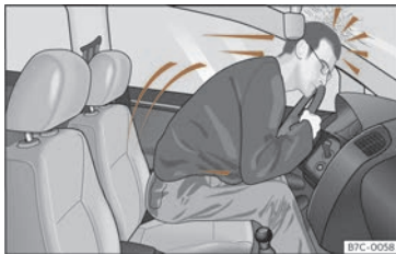
Abb. 17 Der nicht angegurte Fahrer wird nach vorn geschleudert.
