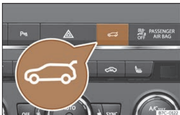
Abb. 56 Mittelkonsole: Taste zum Öffnen und Schließen der Heckklappe.
