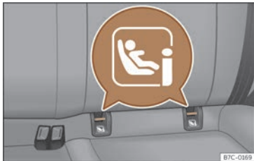
Abb. 35 Rücksitz: Einbauort der Halteösen ISOFIX oder i-Size.
