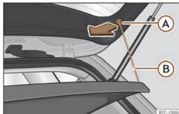
Abb. 157 Im Gepäckraum: Gepäckraumabdeckung aus- und einbauen.
