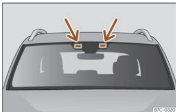
Abb. 88 Bereiche für das Anbringen elektronischen Zubehörs
