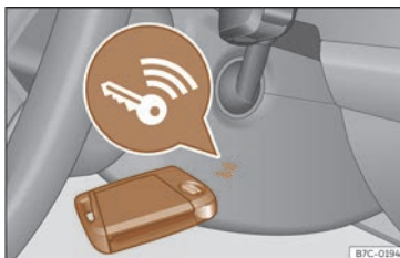
Abb. 90 Rechts an der Lenksäule: Notstart.
