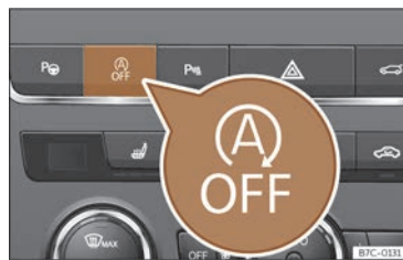
Abb. 91 Mittelkonsole: Systemtaste Start-Stopp.
