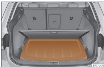
Abb. 160 Im Gepäckraum: Einsetzen der Gepäckraumabdeckung.
