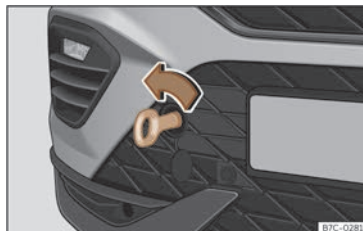
Abb. 184 Vorderer Stoßfänger rechts: Eingeschraubte Abschleppöse
