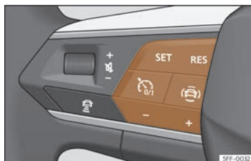
Abb. 107 Am Multifunktionslenkrad: Tasten zur Bedienung der Geschwindigkeitsregelanlage.
