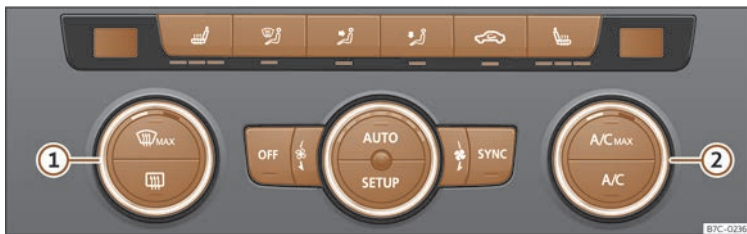
Abb. 86 In der Mittelkonsole: Bedienelemente der Climatronic.
