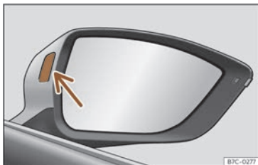
Abb. 121 Kontrollleuchte des Spurwechselassistenten.
