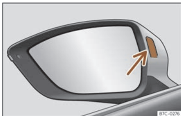
Abb. 120 Kontrollleuchte des Spurwechselassistenten.
