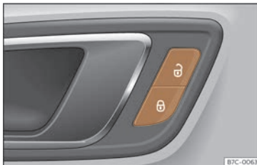
Abb. 49 In der Fahrertür: Zentralverriegelungstaster.
