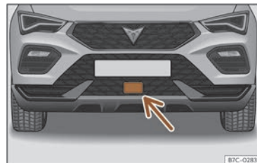
Abb. 101 Im vorderen Stoßfänger: Radarsensor.
