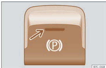
Abb. 124 Im unteren Bereich der Mittelkonsole: Taste für die elektronische Parkbremse.
