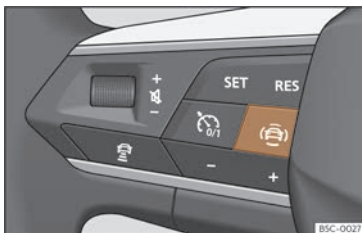
Abb. 100 Linke Seite des Multifunktionslenkrads: Taste für die Fahrerassistenzsysteme (modellabhängig).
