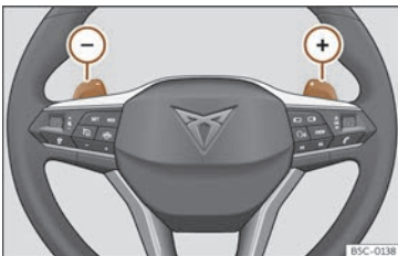
Abb. 94 Lenkrad: die Hebel für Automatikgetriebe.
