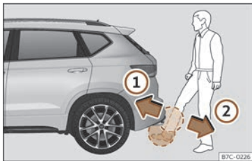
Abb. 57 Heckklappe mit sensorgesteuerter Öffnung (Easy Open).
