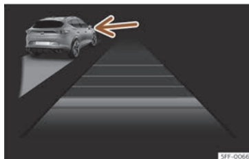
Abb. 111 Am Bildschirm des Kombi- Instrumentenbretts: ACC aktiv, Fahrzeug auf der linken Seite erkannt.
