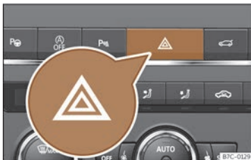
Abb. 40 Instrumententafel: Schalter für die Warnblinkanlage
