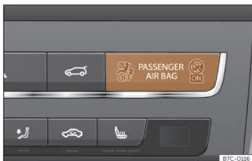
Abb. 26 Instrumententafel: Kontrollleuchte für abgeschalteten Beifahrerairbag.
