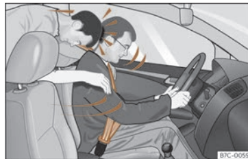
Abb. 18 Der nicht angegurte Mitfahrer auf dem Rücksitz wird nach vorn auf den angegurten Fahrer geschleudert.
