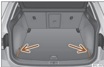
Abb. 159 Im Gepäckraum: Abdeckungen zum Verstauen der Gepäckraumabdeckung.
