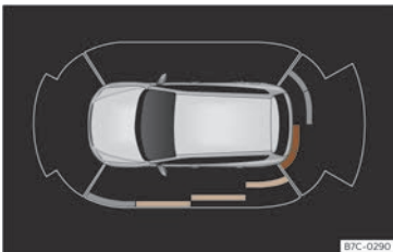
Abb. 129 Anzeige der Einparkhilfe auf dem Bildschirm des Infotainment-Systems.
