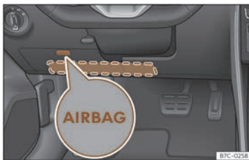
Abb. 30 Auf der Fahrerseite: Einbauort des Knieairbags.
