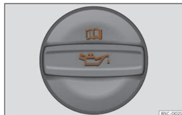
Abb. 200 Deckel der Motoröleinfüllöffnung im Motorraum.
