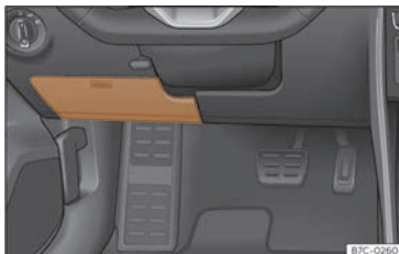
Abb. 187 Auf der Fahrerseite in der Instrumententafel: Abdeckung des Sicherungskastens.
