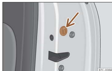
Abb. 76 Notfallsperre der Tür.
