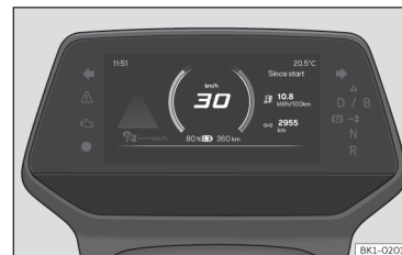
Abb. 1 Digital Cockpit in der Schalttafel
