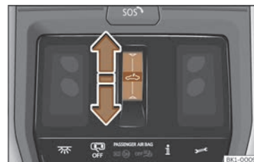
Abb. 90 Im Dachhimmel: Funktionsfläche zur Bedienung des Sonnenschutzrollos
