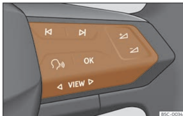
Abb. 71 Bedienelemente am Lenkrad
