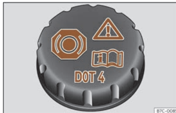
Abb. 159 Frontraum: Deckel des Bremsflüssigkeitsbehälters.
