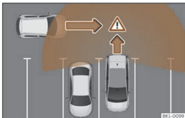
Abb. 115 Schematische Abbildung des Ausparkassistenten: Überwachter Bereich des ausparkenden Fahrzeugs.
