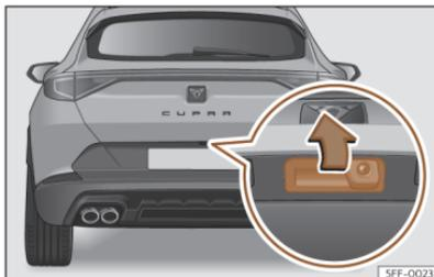
**Abb. 75** Heckklappe: Öffnen von außen
