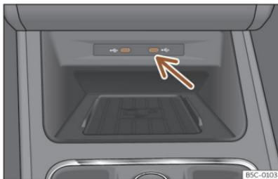
**Abb. 165** Mittelkonsole: USB-Eingang.
