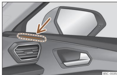
**Abb. 143** Kontrollleuchte des Spurwechselassistenten.
