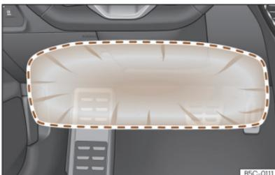
**Abb. 37** Auf der Fahrerseite: Wirkungsbereich des Knieairbags.
