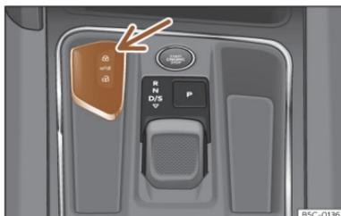
Abb. 64 Mittelkonsole: Aufnahme für den Fahrzeugschlüssel
