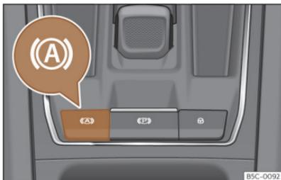
**Abb. 147** Im unteren Bereich der Mittelkonsole: Funktionstaste Auto Hold.
