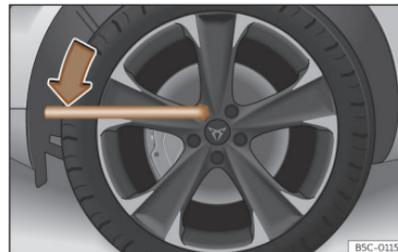
**Abb. 226** Radwechsel: Radschrauben lockern
