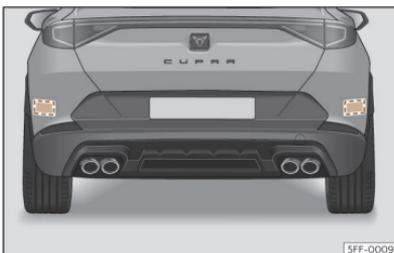
**Abb. 125** Bereich hinter dem Fahrzeug: Bereiche der Radarsensoren.
