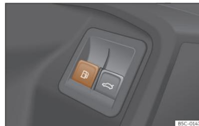
**Abb. 192** Fahrertür: Tankklappenentriegelung.
