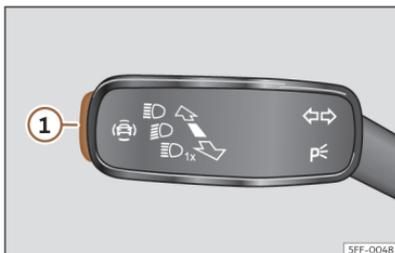
**Abb. 120** Am Blinker- und Fernlichthebel: Taste für die Fahrerassistenzsysteme (modellabhängig).
