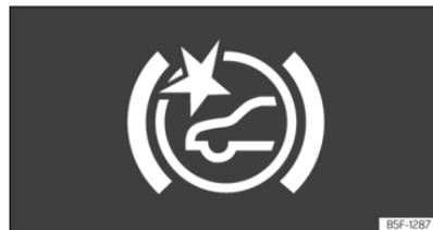
**Abb. 135** Im Display des Kombi-Instruments: Vorwarnhinweise.
