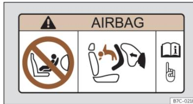
Abb. 39 Airbag-Label: an der Sonnenblende Beifahrerseite.
