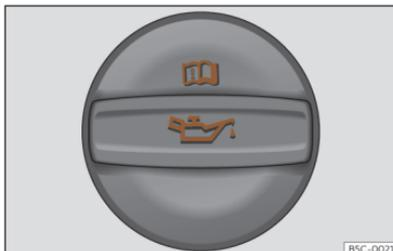
Abb. 216 Deckel der Motoröleinfüllöffnung im Motorraum.
