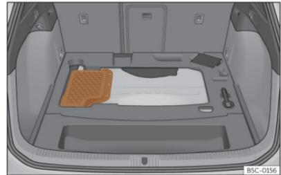
**Abb. 217** Plug-in-Hybridfahrzeuge (PHEV): Einbauort der Batterie im Kofferraum
