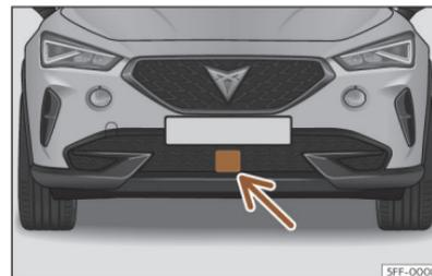
**Abb. 122** Im vorderen Stoßfänger: Radarsensor.
