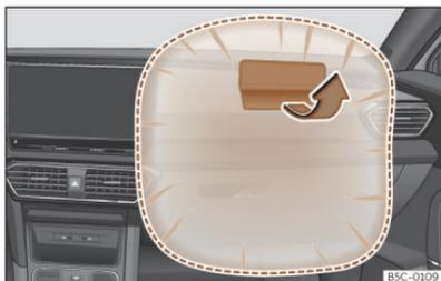
**Abb. 28** Beifahrerairbag in der Instrumententafel
