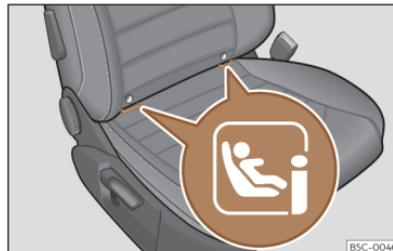
**Abb. 42** Beifahrersitz: Einbauort der Halteösen i-Size.
