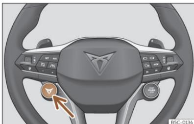
**Abb. 118** Multifunktionslenkrad: Schalter für den Fahrprofilwechsel.
