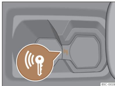
Abb. 113 In der Mittelkonsole: Notstart.
