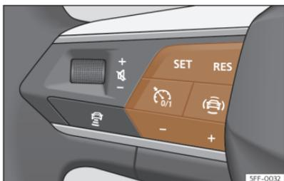
**Abb. 129** Am Multifunktionslenkrad: Tasten zur Bedienung des Geschwindigkeitsbegrenzers.
