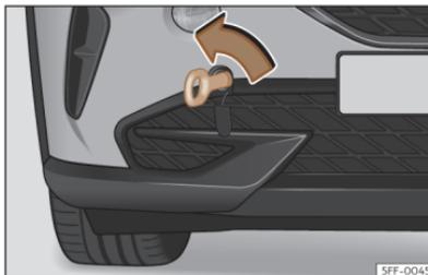
**Abb. 200** Vorderer Stoßfänger rechts: Eingeschraubte Abschleppöse
