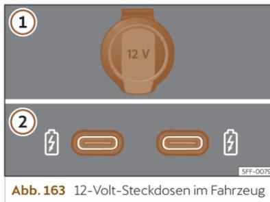
Abb. 163 12-Volt-Steckdosen im Fahrzeug
