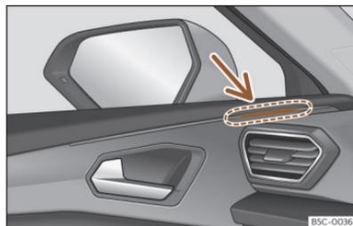
**Abb. 142** Kontrollleuchte des Spurwechselassistenten.
