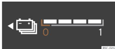
Abb. 5 Digitales Kombi-Instrument: Anzeige des Batterieladezustands.
