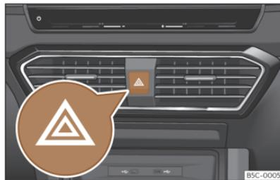
**Abb. 49** Instrumententafel: Schalter für die Warnblinkanlage
