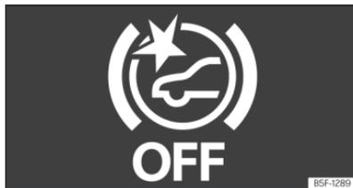
**Abb. 137** Auf dem Display des Kombi-Instruments: Anzeige, dass Front Assist ausgeschaltet ist.
