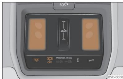
**Abb. 101** Ausschnitt aus Dachhimmel: Innenbeleuchtung vorn.
