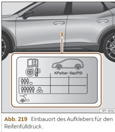
**Abb. 219** Einbaulage des Aufklebers für den Reifendruck.
