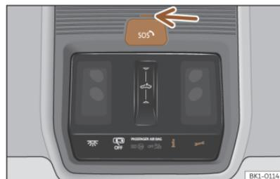
**Abb. 50** In der Dachkonsole: Schalter für Sprachdienste.
