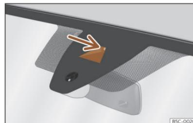
Abb. 124 Kamerasichtfenster des Spurhalteassistenten.
