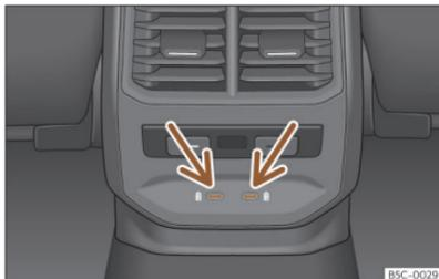
**Abb. 166** Mittelkonsole hinten: USB-Anschlüsse mit Steckdosenfunktion.
