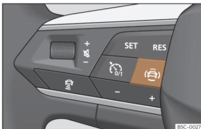
**Abb. 121** Linke Seite des Multifunktionslenkrads: Taste für die Fahrerassistenzsysteme (modellabhängig).
