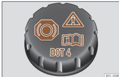
Abb. 211 Frontraum: Deckel des Bremsflüssigkeitsbehälters.
