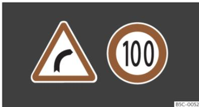
**Abb. 9** Im Display des Kombi-Instruments: Beispiel für erkannte Verkehrszeichen.
