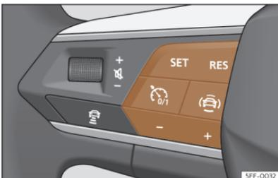
**Abb. 128** Am Multifunktionslenkrad: Tasten zur Bedienung der Geschwindigkeitsregelanlage.
