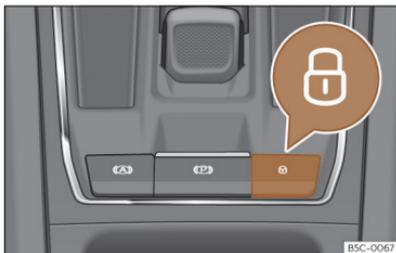
**Abb. 71** In der Mittelkonsole: Zentralverriegelungstaster
