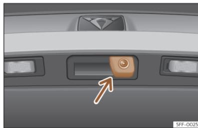
**Abb. 127** Im Griff der Heckklappe: Einbauort der Kamera des Rückfahrassistenten.
